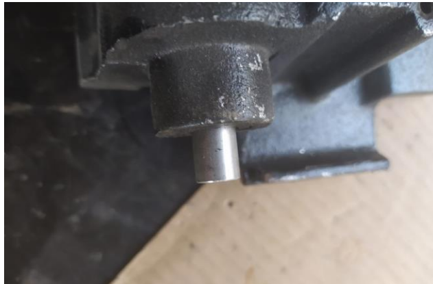
Figura 25. Perno de bloqueo actualizado.
