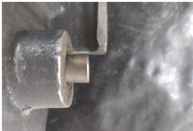
Figura 24. Perno de bloqueo anterior.
